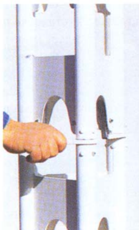
Рис. 1.16. Алюминиевая опора HD 200 для больших нагрузок до 200 кН фирмы PERI: а - общий вид; б, в - монтаж секций; г - устройство спуска
